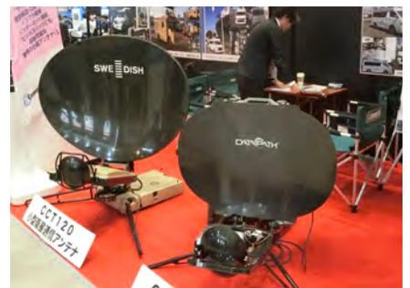
小型衛星通信アンテナ SWEDISH CCT120, Ku/GX サービス両対応の QCT90 アンテナ
