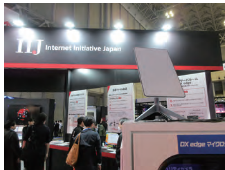
写真4 IJ社は、同社製のマイクロデータセンター設備の上に「Starlink」LEO衛星の小型受信平面アンテナを搭載してネットワーク化するコンセプトを紹介していた。
