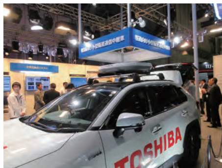
写真2 東芝は、車上に米Kymeta社製のKuバンド対応の平面アンテナ「u8」を搭載した小型衛星通信中継車を展示して意表を突いた。
