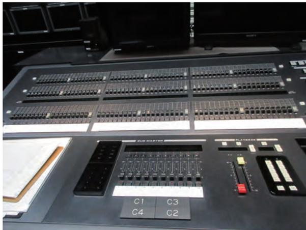
写真4 「Aスタジオサブ」には、パナソニック製大型ビデオスイッチャー、ソニーのカメラコントロールユニットなどが装備されていた。
