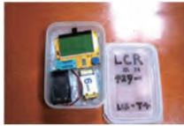
左の写真は筆者が使っている LCR-T4 です。むき出しでタッパーに入れて使用しています。このシリーズには様々なバージョンがあり、アマゾン販売の最新機種ではリモコンなどの赤外線チェックもできます。筆者は放電前のコンデンサーチェックで何度か通していますので、ケースに実装しないで交換できるように基板のまま使っています。一番シンプルなバージョンで9000円位です。
