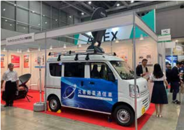
写真1 スカイネットワークは、「スズキ エブリィ」の車上にカナダのC-COM社製のKuバンド対応の自動補足アンテナを搭載した簡易型衛星通信車載局を出展して注目を集めた。
