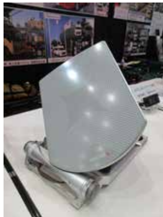
写真2 エーティコミュニケーションズ社のブースでは、今回もKuバンドに対応する超小型ながらも高性能を発揮する「SATCUBE」平面アンテナが目を引いた。
