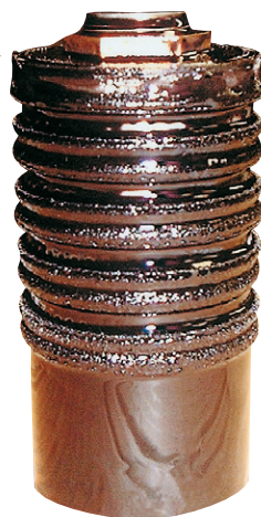
図II. 二次摩耗状態図 (5000~10000km走行時)
